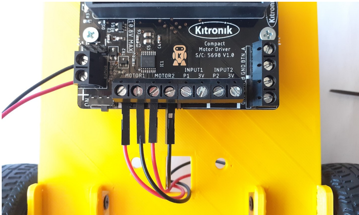
Εικόνα 21: Συνδέοντας του 2 κινητήρες DC στον οδηγό κινητήρων Compact
